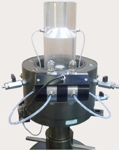
**概述:** GDS 非饱和土三轴试验系统 (UNSAT) 是对传统三轴试验的延伸, 可以在接近实际地应力状态和饱和度条件下对地下水位以上的土体进行测试。所有 GDS 三轴测试系统 (以及其他制造商的三轴设备\*) 都可以进行改造, 以进行非饱和土三轴测试。GDS 可以提供 4 种方法来进行非饱和土测试。
