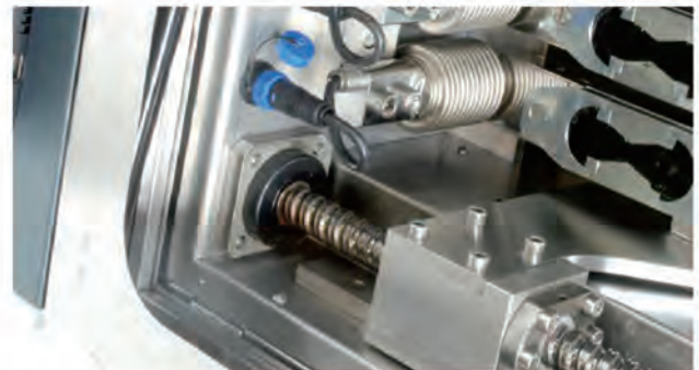
81-PV10C12 细部展示，配置了4个81-PV10020荷载传感器和沥青试样模具
